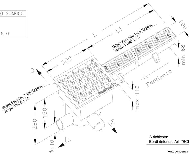
Acciaio Aisi 304 (a richiesta Aisi 316) - Spessore costruttivo 2 mm
