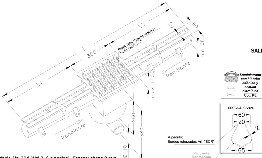
Acero inoxidable Aisi 304 (Aisi 316 a pedido) - Espesor chapa 2 mm
