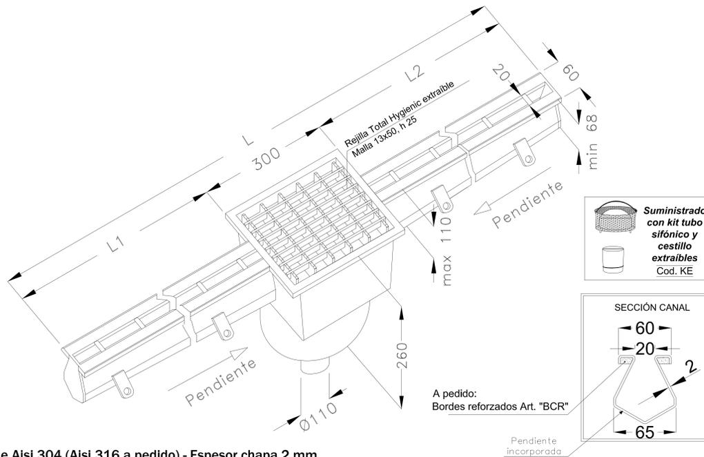
Acero inoxidable Aisi 304 (Aisi 316 a pedido) - Espesor chapa 2 mm
