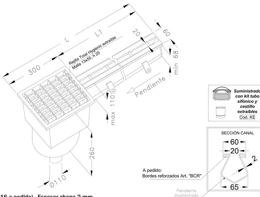
Acero inoxidable Aisi 304 (Aisi 316 a pedido) - Espesor chapa 2 mm
