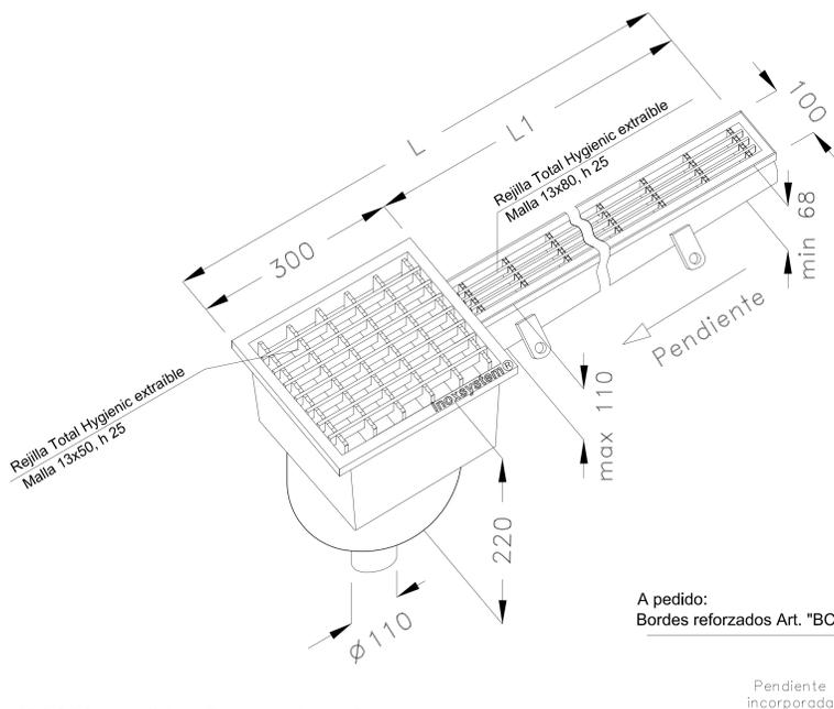
Acero inoxidable Aisi 304 (Aisi 316 a pedido) - Espesor chapa 2 mm
