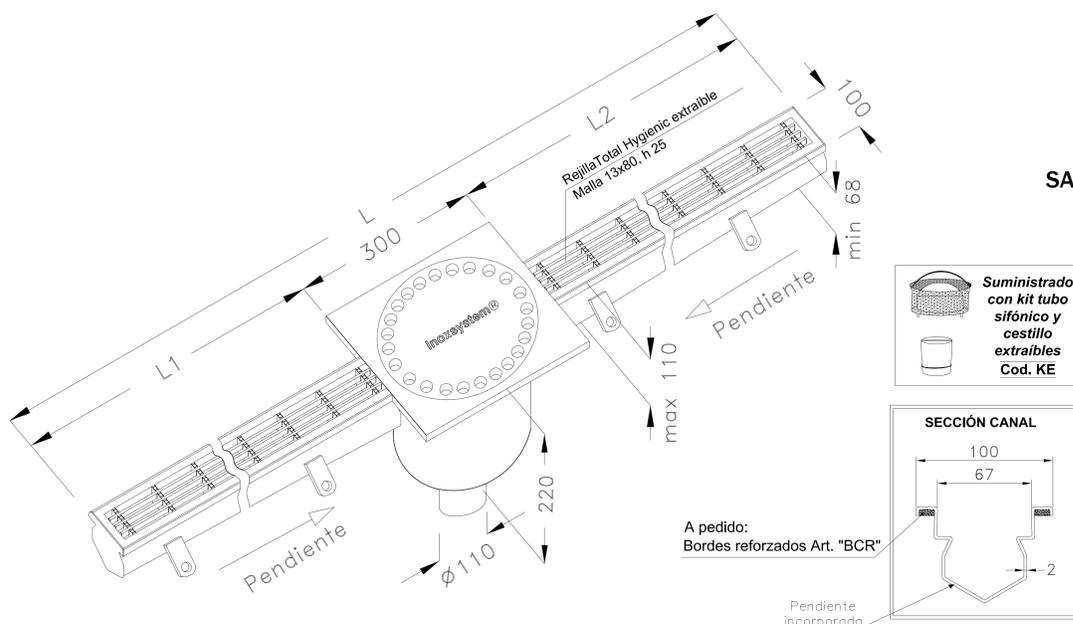
Acero inoxidable Aisi 304 (Aisi 316 a pedido) - Espesor chapa 2 mm
