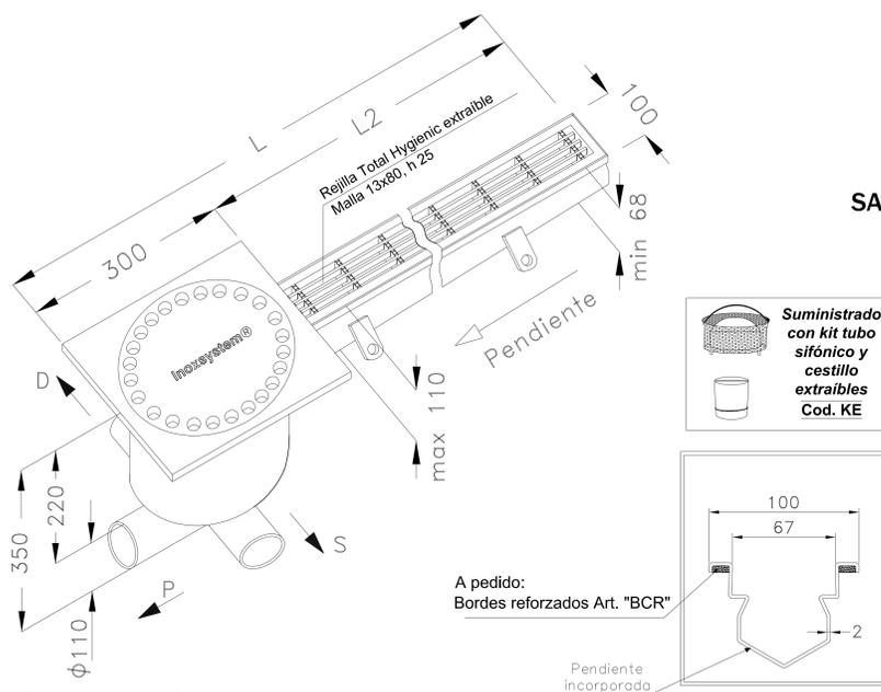
Acero inoxidable Aisi 304 (Aisi 316 a pedido) - Espesor chapa 2 mm
