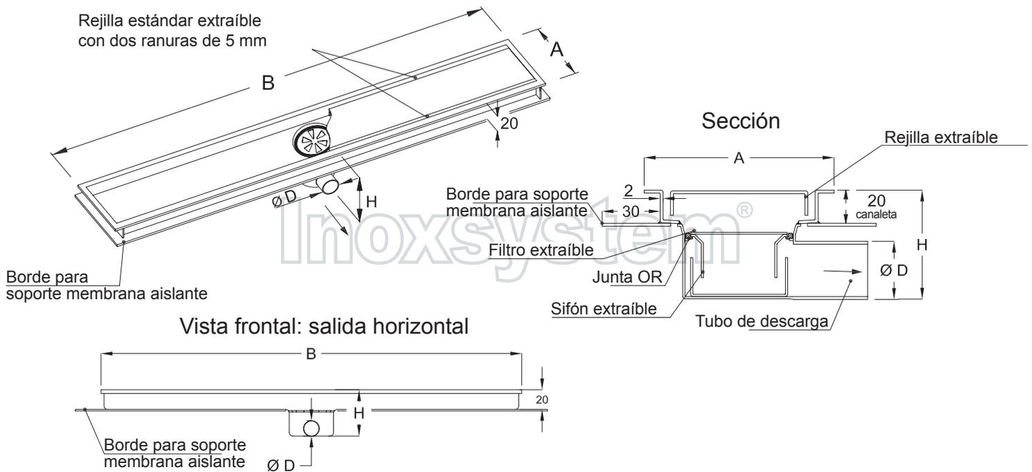
Inoxsystem® IDrain 3070 - Canaleta con rejilla estándar cerrada con dos ranuras - 100 mm de ancho - marco con bordes visibles - salida central horizontal Ø 40 - sifón y filtro extraíbles - con borde para soporte membrana aislante
