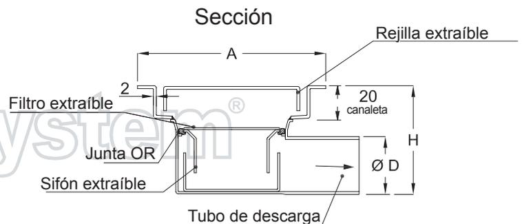
Inoxsystem® IDrain 3060 - Canaleta con rejilla estándar cerrada con dos ranuras - 100 mm de ancho - marco con bordes visibles - salida central horizontal Ø 40 - sifón y filtro extraíbles
