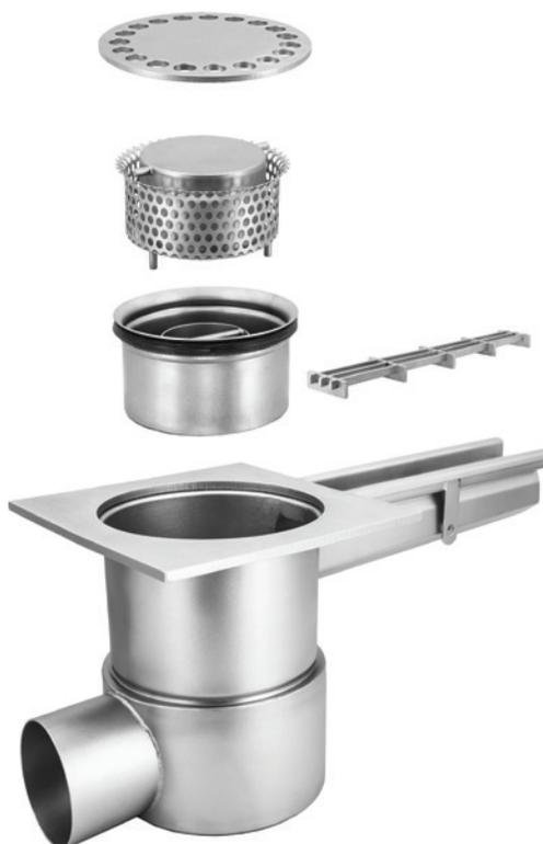
**Consigli:** - La tipologia di sifone con tazza permette di poter estrarre quest'ultima con l'acqua sporca ancora al proprio interno, senza dover drenare tutto direttamente nello scarico del chiusino. Ricordiamo che, una volta completata la pulizia, si raccomanda di riempire l'interno del pozzetto con dell'acqua nuova per rimettere in funzione il sifone anti-odore.
