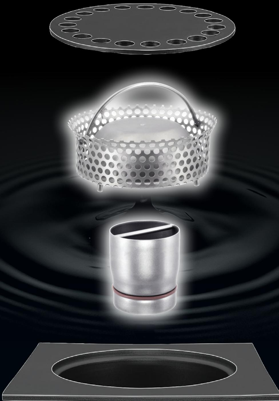
**Consigli:** La tipologia di sifone con tubo estraibile è studiata per permettere, mediante la semplice rimozione dello stesso, il completo drenaggio dell'acqua presente all'interno del chiusino e dunque una totale pulizia del pozzetto. Ricordiamo che, una volta completata la pulizia, si raccomanda di riempire l'interno del pozzetto con dell'acqua nuova per rimettere in funzione il sifone anti-odore.
