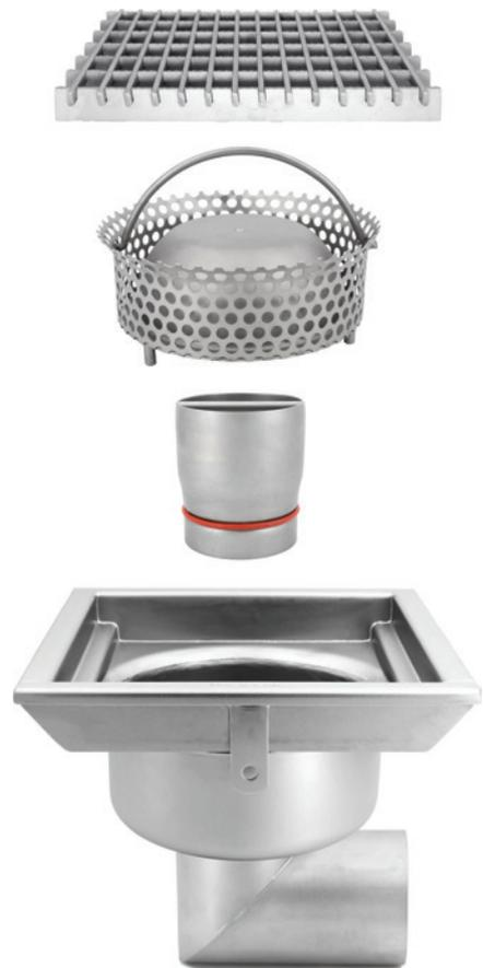
**Consigli:** - La tipologia di sifone con tubo estraibile è studiata per permettere, mediante la semplice rimozione dello stesso, il completo drenaggio dell'acqua presente all'interno del chiusino e dunque una totale pulizia del pozzetto. Ricordiamo che, una volta completata la pulizia, si raccomanda di riempire l'interno del pozzetto con dell'acqua nuova per rimettere in funzione il sifone anti-odore.
