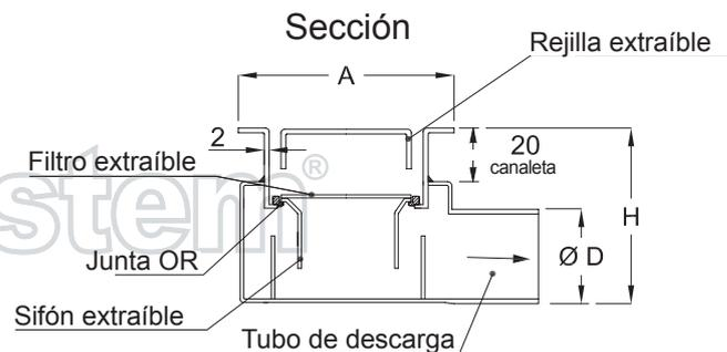
Inoxsystem® IDrain 3080 - Canaleta con rejilla estándar cerrada con dos ranuras - 70 mm de ancho - marco con bordes visibles - salida central horizontal Ø 40 - sifón y filtro extraíbles
