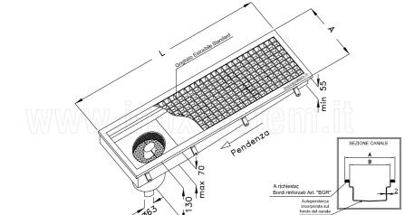
Acciaio Alsi 304 (a richiesta Alsi 316) - Spessore costruttivo 2 mm
